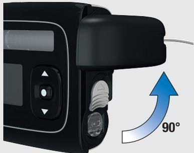
Drehen Sie den Adapter gegen den Uhrzeigersinn in eine 90°-Position.
