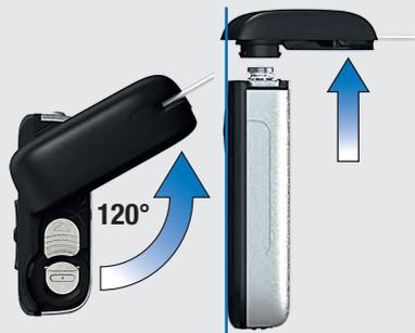
Entfernen Sie den Adapter mit der Ampulle, wenn ein Winkel von ungefähr 120° erreicht ist. Die Pumpe fährt die Gewindestange zurück.
