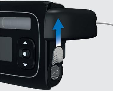
Schieben Sie die Batteriefachdeckel-Entriegelung in Pfeilrichtung (zum Ampullenfach hin).
