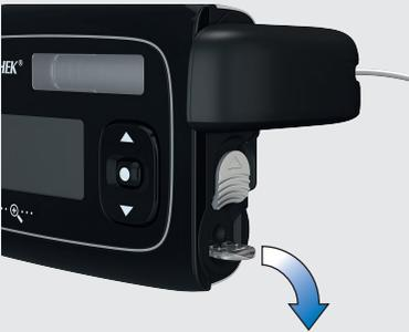
Mit der aufstellbaren Greifhilfe lässt sich der Batteriefachdeckel leichter entfernen.
