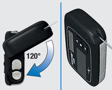
Drehen Sie den Adapter im Uhrzeigersinn bis zum Anschlag. Der Adapter ist korrekt ausgerichtet, wenn er bündig mit dem Pumpengehäuse abschließt.
