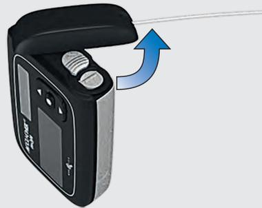
Halten Sie die Pumpe senkrecht. Drehen Sie den Adapter mit dem Schlauch gegen den Uhrzeigersinn.
