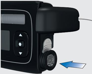
Drücken Sie den Batteriefachdeckel vollständig in das Batteriefach hinein, bis er hörbar einrastet.
