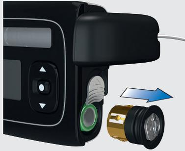
Nehmen Sie den Batteriefachdeckel ab und entnehmen Sie die alte Batterie.
