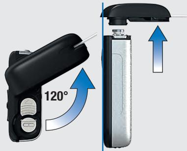
Halten Sie die Pumpe senkrecht. Entfernen Sie den Adapter und die Ampulle und entnehmen Sie die Batterie aus der Insulinpumpe. Siehe Kapitel 2, Seite 17.
