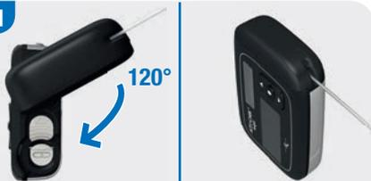
Drehen Sie den Adapter im Uhrzeigersinn bis zum Anschlag. Der Adapter ist korrekt ausgerichtet, wenn er bündig mit dem Pumpengehäuse abschließt. Drücken Sie anschließend zur Bestätigung
