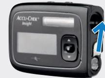
Schieben Sie die Batteriefachdeckel-Entriegelung in Pfeilrichtung (zum Ampullenfach hin).
