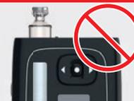
Drücken Sie die Ampulle **nicht** in die Pumpe, wenn die Ampulle hervorsteht. Die Pumpe oder die Ampulle könnte dadurch beschädigt werden. Vergewissern Sie sich, dass die Gewindestange vollständig zurückgefahren wurde. Wenn die Gewindestange nicht vollständig zurückgefahren wurde, **wenden Sie sich an das Accu-Chek Kunden Service Center.**
