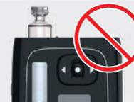
Drücken Sie die Ampulle **nicht** in die Pumpe, wenn die Ampulle hervorsteht. Die Pumpe oder die Ampulle könnte dadurch beschädigt werden. Vergewissern Sie sich, dass die Gewindestange vollständig zurückgefahren wurde. Wenn die Gewindestange nicht vollständig zurückgefahren wurde, **wenden Sie sich an das Accu-Chek Kunden Service Center.**
