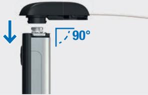
Setzen Sie einen neuen Adapter auf den Bajonettverschluss des Ampullenfachs. Achten Sie darauf, dass Sie die Nase des Adapters in einem rechten Winkel (90°) in die Aussparungen des Pumpengehäuses einführen. Anderenfalls könnte sich die Nadel verbiegen.
