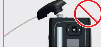
Setzen Sie den Adapter **nicht** auf den Bajonettverschluss des Ampullenfachs, wenn der Adapter nicht wie in **Schritt 10** beschrieben positioniert wurde.
