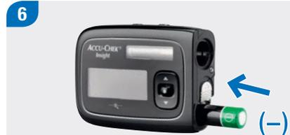
Legen Sie die neue Batterie mit dem Pluspol (+) zuerst in das Batteriefach ein; der Minuspol (-) muss nach außen zeigen.
