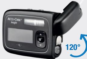
Drehen Sie den Adapter gegen den Uhrzeigersinn in eine 120°-Position.
