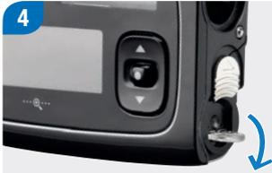
Mit der aufstellbaren Greifhilfe lässt sich der Batteriefachdeckel leichter entfernen.
