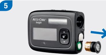
Nehmen Sie den Batteriefachdeckel ab und entnehmen Sie die alte Batterie.
