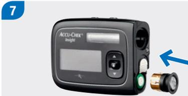
Bringen Sie den Batteriefachdeckel über der Batterie an.
