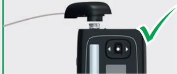
Setzen Sie den Adapter **nur** wie in **Schritt 10** beschrieben auf den Bajonettverschluss des Ampullenfachs.
