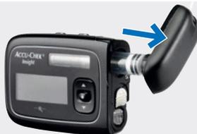
Entfernen Sie den Adapter und die Ampulle und entnehmen Sie die Batterie aus der Insulinpumpe. Siehe Kapitel 2, Seite 13.
