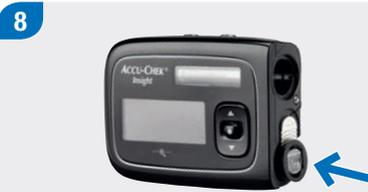
Drücken Sie den Batteriefachdeckel vollständig in das Batteriefach hinein, bis er hörbar einrastet.
