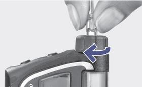
Überprüfen Sie, ob der Luer-Anschluss des Infusionssets noch ordnungsgemäß an den Adapter angeschlossen ist. Ziehen Sie das Infusionsset von Hand im Uhrzeigersinn fest, bis es fest im Adapter sitzt.
