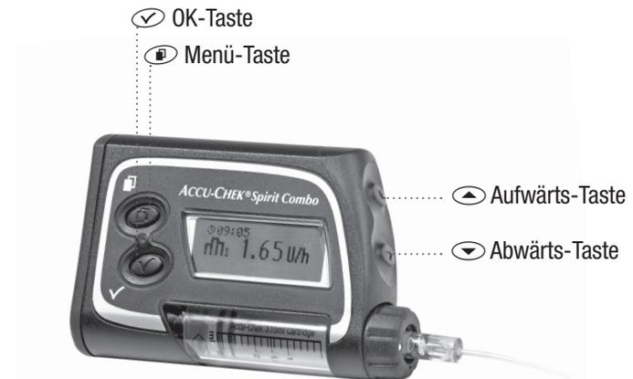
**Hinweis** Drücken Sie niemals mit Ihren Fingernägeln oder anderen spitzen Gegenständen auf die Tasten. Dadurch kann die Gummibeschichtung der Tasten beschädigt werden, was weitere Folgeschäden nach sich ziehen kann.
