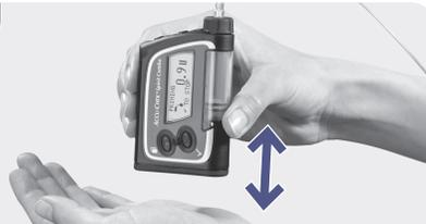
Um sicherzustellen, dass etwaige Luftblasen entweichen können, sollten Sie die Pumpe immer senkrecht halten und mit der Unterseite leicht auf die flache Hand klopfen.
