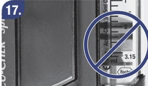
Wenn die Abschlussplatte der Gewindestange nicht bündig mit dem Ampullenstopfen ist, nehmen Sie die Ampulle wieder aus dem Ampullenfach heraus und wiederholen Sie die Schritte 9 bis 14.
