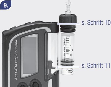
Halten Sie Ihre Pumpe senkrecht. Halten Sie die neue gefüllte Ampulle mit dem angeschlossenen Adapter und dem Infusionsset nach oben, parallel direkt neben das Ampullenfach.
