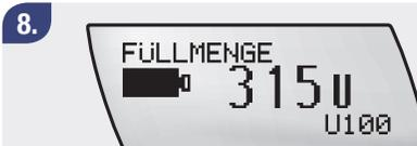
Sobald die Gewindestange vollständig zurückgefahren ist, erscheint die Anzeige FÜLLMENGE mit der maximalen Füllmenge von 315 U.
