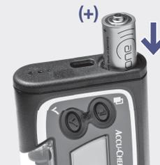
Legen Sie die Batterie mit dem Minuspol (-) voran und dem Pluspol (+) nach oben ins Batteriefach ein.
