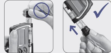
Halten Sie die Pumpe **nicht** senkrecht, wenn Sie die Ampulle einsetzen.
