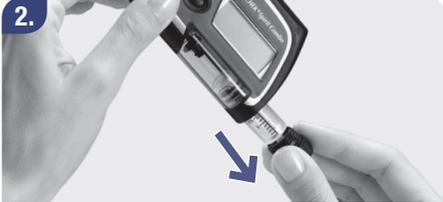
Entfernen Sie Ampulle, Adapter und Infusionsset.
