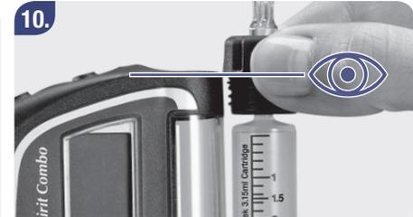
Achten Sie darauf, dass der obere Rand mit dem Gewindeteil des Adapters bündig ist mit dem Ende des Ampullenfachs.
