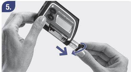
5. Nehmen Sie den Adapter und die Ampulle aus der Pumpe heraus, indem Sie den Adapter aus dem Pumpengehäuse herausschrauben.
