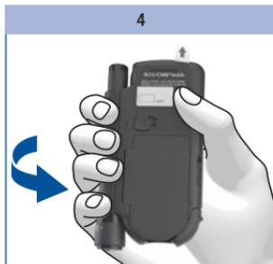
Drehen Sie das Messgerät mit der Rückseite nach vorn.
