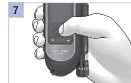
Drücken Sie ca. 2 Sekunden, bis sich das Messgerät einschaltet.
