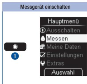
Langes Drücken der Taste
