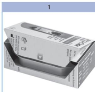
Öffnen Sie die Verpackung der Testkassette an der Perforation. Entnehmen Sie den Kunststoffbehälter.
