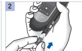
Setzen Sie die neue Lanzettentrommel mit dem weißen Ende voran ein.
