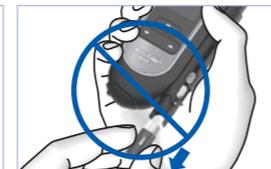
Entfernen Sie die Lanzettentrommel **nicht**, bevor alle 6 Lanzetten aufgebraucht sind.
