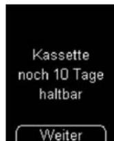
Diese Meldung erscheint am Beginn einer Messung, wenn die Testkassette nur noch 10 Tage haltbar ist. Die Meldung wird wiederholt, wenn die Testkassette noch 5, 2 und 1 Tag(e) haltbar ist.
