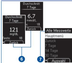
**Zurück 6** (Taste
