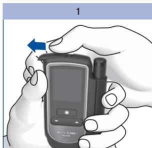
Schieben Sie den Batteriefachdeckel bis zum Anschlag in Pfeilrichtung auf.
