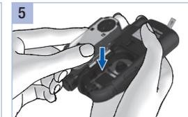
Legen Sie die Testkassette in das Messgerät. Drücken Sie den Kassettendeckel zu. Schließen Sie den Spitzenschutz.
