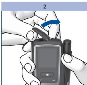
Klappen Sie den Batteriefachdeckel nach oben.
