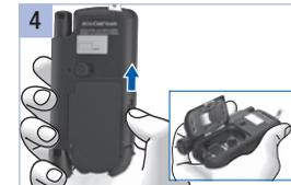
Schieben Sie den Entriegelungsknopf für den Kassettendeckel in Pfeilrichtung nach oben.
