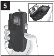
5 Schieben Sie den Entriegelungsknopf für den Kassettenfachdeckel in Pfeilrichtung nach oben, um den Kassettenfachdeckel zu öffnen.
