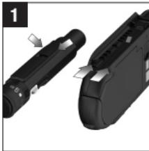
Beim Andocken müssen die Führungsschienen der Stechhilfe und des Messgeräts ineinandergriften.
