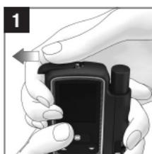
1 Schieben Sie den Batteriefachdeckel bis zum Anschlag in Pfeilrichtung, um ihn zu öffnen.
