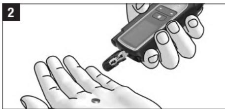
Drehen Sie das Messgerät um und lassen Sie die Pufferbatterie herausfallen.
