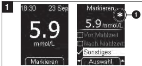
Das Menü **Markieren** wird angezeigt. Hier können Sie den Glukosewert markieren. Sie können zwischen 4 verschiedenen Markierungen wählen. Das Symbol der eingeschalteten Markierung wird rechts über dem Glukosewert angezeigt. Im Beispiel ist der Glukosewert mit dem Symbol **Sonstiges** markiert 1.
