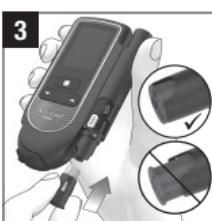
Setzen Sie die neue Lanzettentrommel mit dem weißen Ende voran ein.
