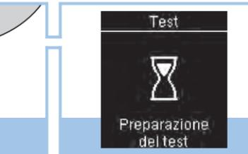
Inserire l'estremità metallica della striscia reattiva nel misuratore. Il misuratore si accende. Appare **Preparazione del test**.
