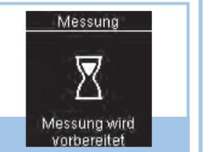
Das Messgerät schaltet sich ein. **Messung wird vorbereitet** erscheint auf dem Display.
