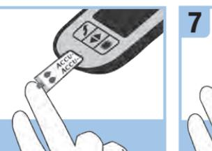
Berühren Sie mit der **gelben Blutauftragsfläche** des Teststreifens den Blutropfen. Tragen Sie das Blut nicht auf die Oberseite des Teststreifens auf.
