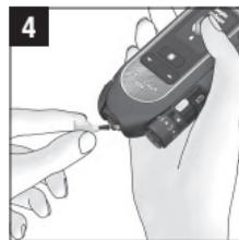
Effleurez le centre de la zone réactive à l'extrémité de la cassette avec la pointe du pinceau pour déposer de la solution de contrôle.
