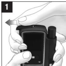
**1** Faites glisser le couvercle du compartiment des piles dans le sens de la flèche jusqu'à la butée.
