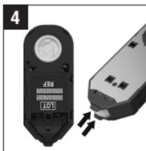
Vérifiez si des souillures se trouvent à l'intérieur de l'extrémité de la cassette. Si tel est le cas, éliminez les souillures avec soin.
