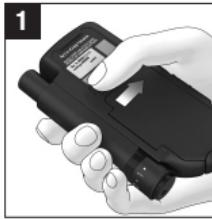
Faites glisser le cran de sécurité de l'autopiqueur dans le sens de la flèche jusqu'à la butée. Maintenez-le dans cette position.
