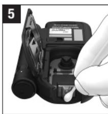
Passez un chiffon ou un coton-tige légèrement humidifié sur la lentille de mesure et sur la partie avant de l'ouverture de l'appareil.
