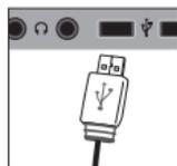
Connectez l'extrémité plus large d'un câble USB au port USB du PC.
