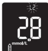
Le résultat de contrôle, le symbole du flacon et l'affichage clignotant L1 ou L2 apparaissent à l'écran. Appuyez sur la touche ▼ et maintenez-la enfoncée pour confirmer le niveau de contrôle que vous avez utilisé pour le test de contrôle.
