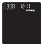
Appuyez sur la touche ▼ et maintenez-la enfoncée jusqu'à ce que **set-up** (configuration) apparaisse à l'écran. L'heure clignote.
