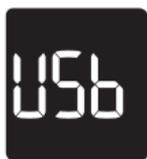
Le lecteur est connecté à un PC et aucune mesure de glycémie ni aucun test de contrôle ne peut avoir lieu.
