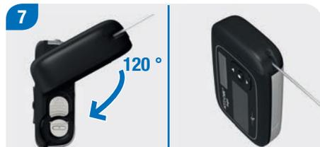
Tournez l'adaptateur dans le sens des aiguilles d'une montre jusqu'à la butée. L'adaptateur est correctement positionné lorsqu'il est aligné avec le boîtier de la pompe. Appuyez ensuite sur la touche
