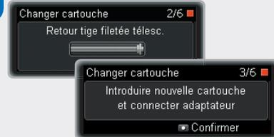
Une fois la tige filetéte dans sa position initiale, vous êtes invité à insérer la nouvelle cartouche et à connecter l'adaptateur. **Insérez une nouvelle cartouche si l'écran **Introduire nouvelle cartouche et connecter adaptateur** s'affiche.**
