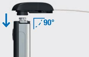
Placez un nouvel adaptateur sur les encoches du compartiment de la cartouche. Assurez-vous d'insérer l'embout de l'adaptateur dans les encoches du compartiment de la cartouche de la pompe à un angle droit (90°). L'aiguille risque d'être tordue dans le cas contraire.
