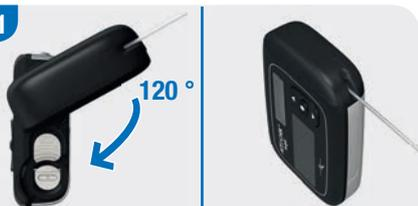
Tournez l'adaptateur dans le sens des aiguilles d'une montre jusqu'à la butée. L'adaptateur est correctement positionné lorsqu'il est aligné avec le boîtier de la pompe. Appuyez ensuite sur la touche
