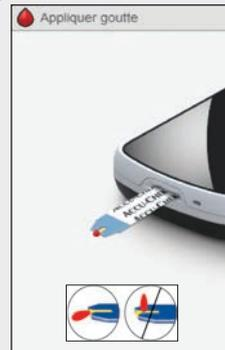
Posez la goutte de sang sur le **bord avant** de la fenêtre jaune de la bandelette réactive. Ne mettez pas de sang sur le dessus de la bandelette réactive.
