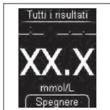
Se l'ultimo (il più recente) risultato in memoria viene visualizzato come XX,X mmol/L insieme a delle lineette al posto di data e ora, significa che l'ultimo test non ha fornito alcun risultato. Ciò significa che durante l'ultimo test è stato
