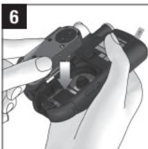
**6** Inserire la cassetta test nel misuratore con il lato argentato rivolto verso l'alto.
