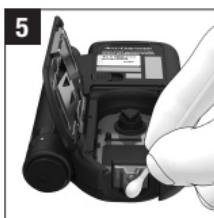
Tamponare con cautela la finestrella di misurazione ottica e l'apertura anteriore del misuratore con un bastoncino di cotone leggermente inumidito.
