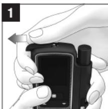
Aprire il coperchio del vano batteria spingendolo fino in fondo nella direzione della freccia.
