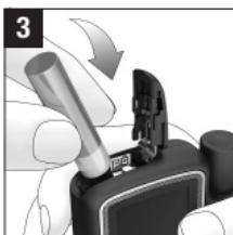
Inserire due batterie nuove nel vano. Prestare attenzione al corretto posizionamento dei poli (+ e -) delle batterie.
