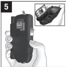
**5** Spingere il tasto cursore del coperchio del vano portacassetta verso l'alto, in direzione della freccia, per aprire il vano.
