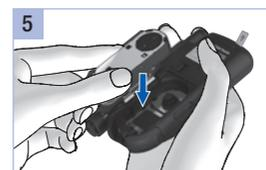
Inserire la cassetta test nel misuratore. Premere il coperchio del vano portacassetta in sede. Chiudere lo sportello.
