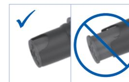
Il caricatore di lancette è inserito correttamente quando è completamente introdotto nel pungidito e ne sporge solo il bordo superiore.
