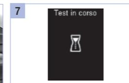
Allontanare il dito dalla cassetta test non appena il misuratore emette un segnale acustico e il messaggio *Test in corso* appare sul display.
