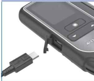
Inserire il connettore Micro B del cavo USB nell'interfaccia USB del misuratore.
