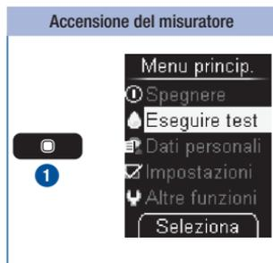
Premere a lungo il pulsante
