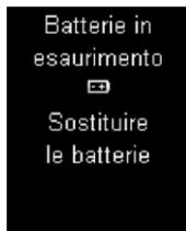
Questa avvertenza appare quando le batterie stanno per esaurirsi. Finché non si sostituiscono le batterie, questa avvertenza riapparirà ogni volta che si spegne il misuratore. Dopo la prima visualizzazione dell'avvertenza si possono eseguire ancora 50 test circa.
