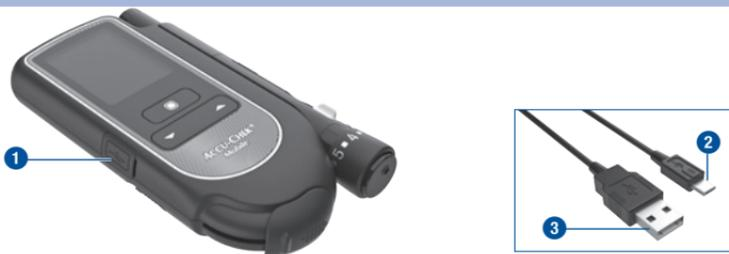
Per collegare il misuratore ad un computer è necessario un cavo USB. Il cavo USB deve avere i seguenti connettori:
