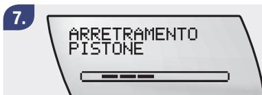
L'asta del pistone inizia ad arretrare. Non toccare o disturbare in altro modo il pistone mentre sta arretrando poiché si potrebbe danneggiare il microinfusore.
