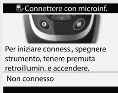
Schermo strumento di misurazione
