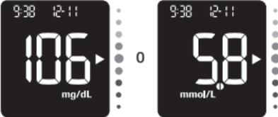
A misuratore spento, premere ▼ per accendere il misuratore. Appare il risultato dell'ultimo test.
