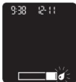
Inserire l'estremità metallica della striscia reattiva nel misuratore. Il misuratore si accende.
